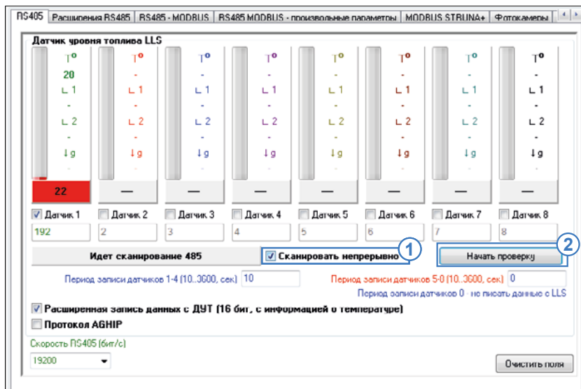
Рис.23. Проверка работы контроллера АвтоГРАФ с датчиками ТКАМ по протоколу LLS.
